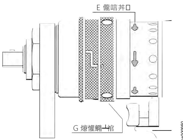
绿色箭头也表示机器的运行方向，即启动时顺时针运行。无需用手使移位环保持在两个位置上。
